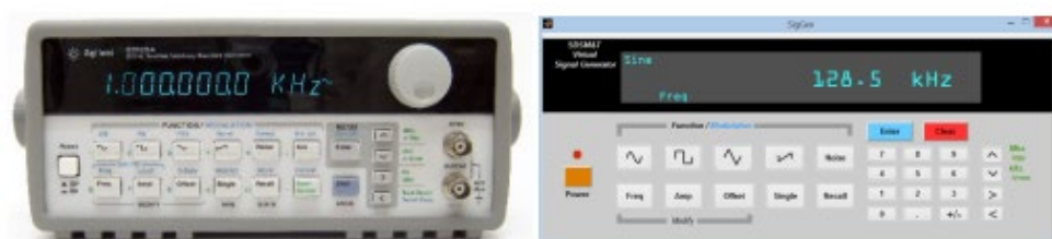
Figura 5. Generador de señales comercial y modelo Simulink correspondiente.
